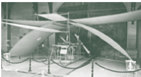
Les concepteurs de l'« autoplane » Aimé-Salmson espèrent que leur aéronef à l'allure singulière pourra décoller verticalement, se déplacer comme un avion conventionnel et atterrir, également de façon verticale, sur n'importe quel terrain de petites dimensions. (1909-05-09 MAVC, Collection austro-hongroise, n° de nég. EX 22)
