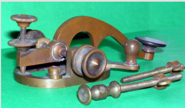
Manipulateur télégraphique dit « à dos de chameau » en raison de l'aspect du levier. Il a été fabriqué entre 1848 et 1869 et utilisé dans un bureau télégraphique de Metcalfe (Ontario).
